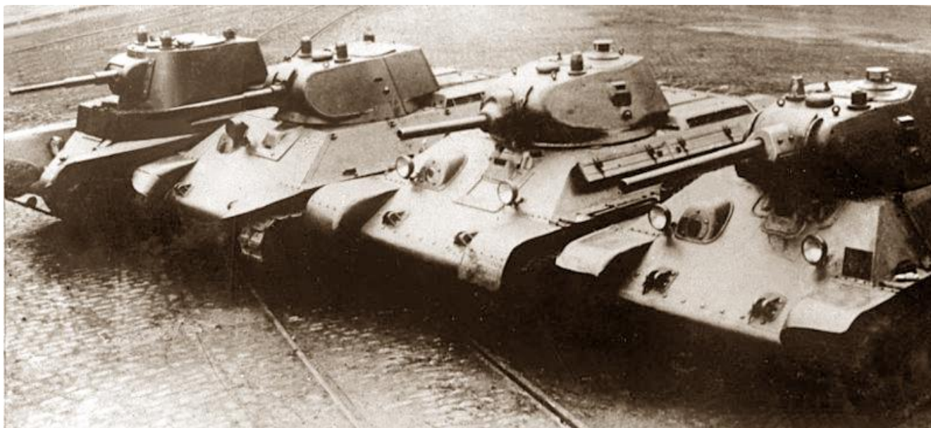
Довоенные танки производства завода № 183. Слева направо: БТ-7, А-20, Т-34-76 с пушкой Л-11, Т-34-76 с пушкой Ф-34.
